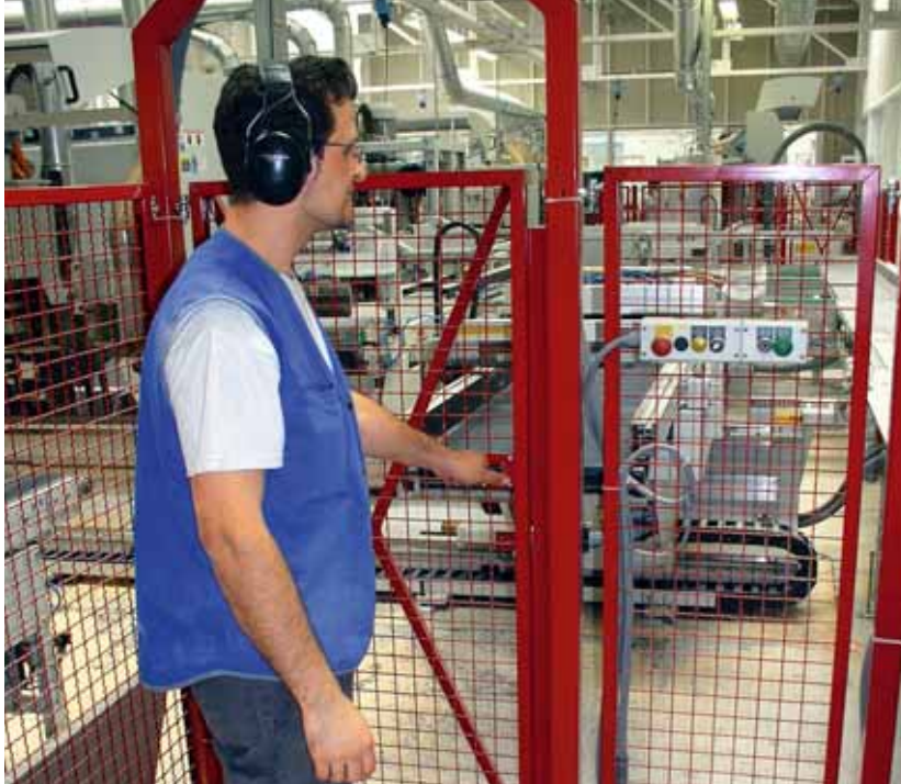
Installation de production automatique entourée d'une grille protectrice. Dès que la porte d'accès munie d'un dispositif de contrôle électrique s'ouvre, toutes les étapes présentant un danger pour la personne entrante sont stoppées.
