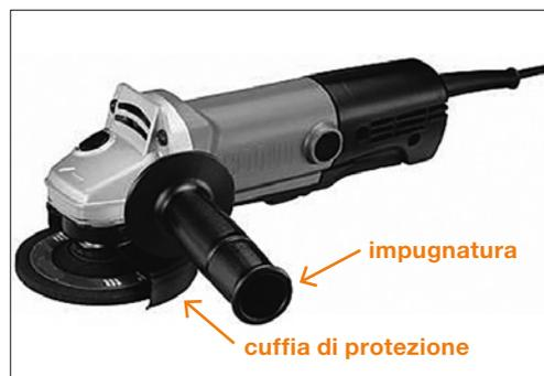
3 Molatrice dotata di dispositivo di protezione originale
