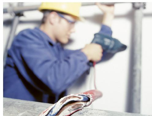
7 Il faut contrôler l'état des câbles, des fiches et des machines électriques portatives avant de les utiliser.
